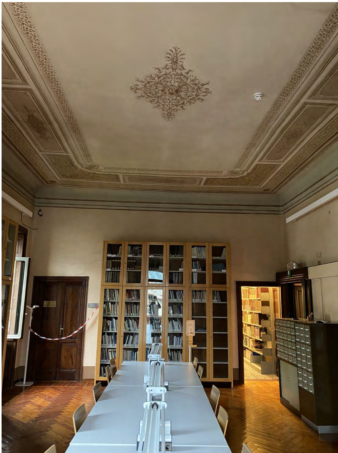
VISTA NUOVI SENSORI IMPIANTO ANTINCENDIO. IL PRECEDENTE SENSORE ERA POSIZIONATO A PARETE, NON ESSENDO A NORMA SI É OPTATO PER UNA POSIZIONE DEFILATA RISPETTO AL DECORO CENTRALE
